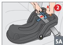
**PASO 4A:** Pasar el cinturón de seguridad del vehículo por la guía del cinturón de seguridad del vehículo, situando la correa de la cadera lo más cerca posible de la parte superior del dispositivo de bloqueo, donde se articula la lengüeta. Abrochar el cinturón de seguridad del vehículo.
