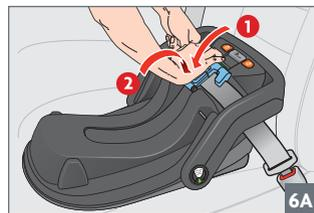
**NOTA:** La base no se debe mover más de 1 pulgada (2,5 cm) de un lado a otro con respecto a la guía del cinturón. Si se desplaza más de 1 pulgada (2,5 cm), tuerza la hebilla y abroche el cinturón de seguridad para que la base quede bien sujeta.
