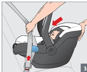
**PASO 1:** Haga pasar la parte de la cinta abdominal del cinturón de seguridad por ambas guías de las cintas abdominales en el cargador abroche el cinturón de seguridad.
