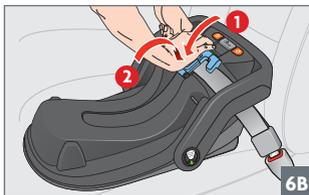
**PASO 6B:** Cerrar la parte superior del dispositivo de bloqueo sobre el cinturón 1. Después, cerrar la parte inferior del dispositivo de bloqueo sobre el cinturón 2. Asegurarse de presionar la parte inferior del dispositivo de bloqueo hasta el fondo hasta oír un chasquido.
