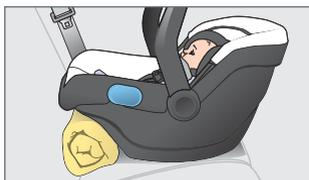
**NOTA:** Para lograr una instalación más estable, puede utilizarse tubos de espuma para piscina o una toalla enrollada.
