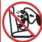
**NUNCA** coloque este dispositivo de retención infantil en un asiento delantero con airbag. Peligro de **MUERTE O LESIONES GRAVES**. Un airbag puede golpear un dispositivo de retención
