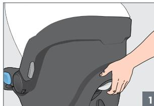
**PASO 1:** Pulse y mantenga presionado el botón para desenganchar el cargador en la parte posterior del cargador.
