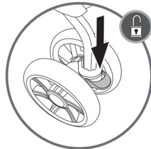
Appuyer sur la pédale avec le pied pour déverrouiller le pivot.
